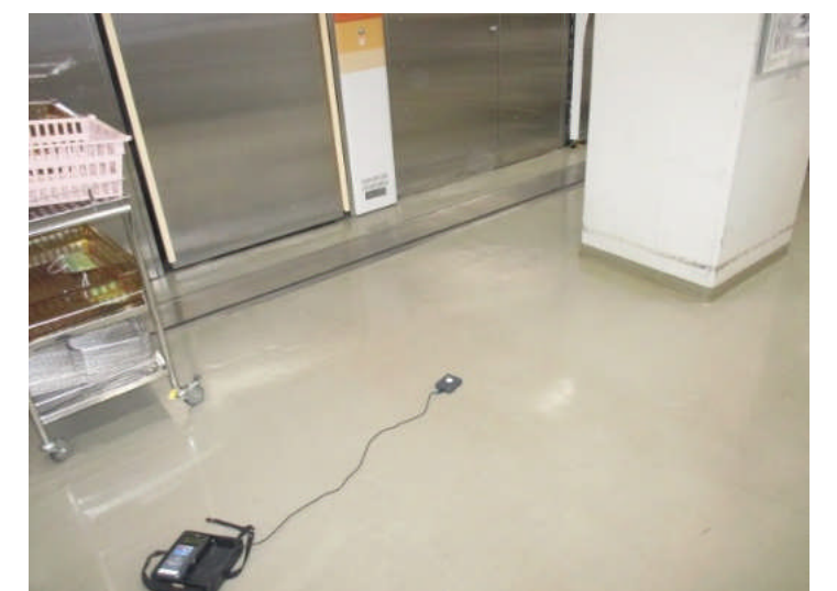
未消毒作業室 照度測定
